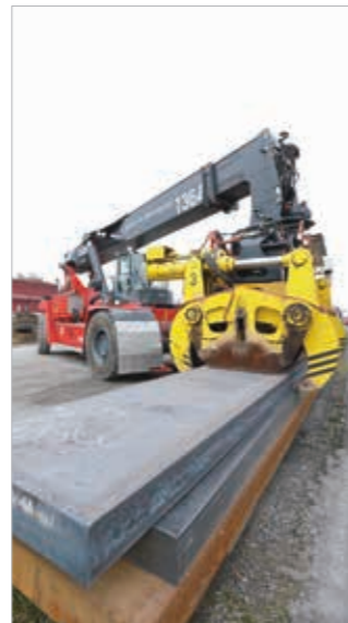
Industrieller Umschlag - Werkzeugwechsler (A)
